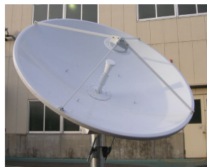
衛星通信地上局用アンテナ
