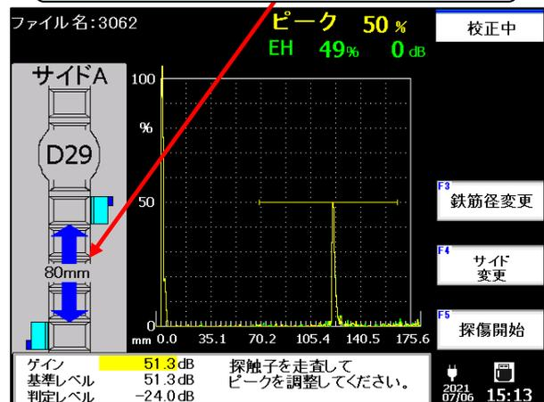
機械式継手 Y0値・鉄筋挿入長さ表示・YD入力
