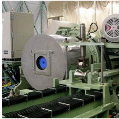
高速ロータリ探傷装置
