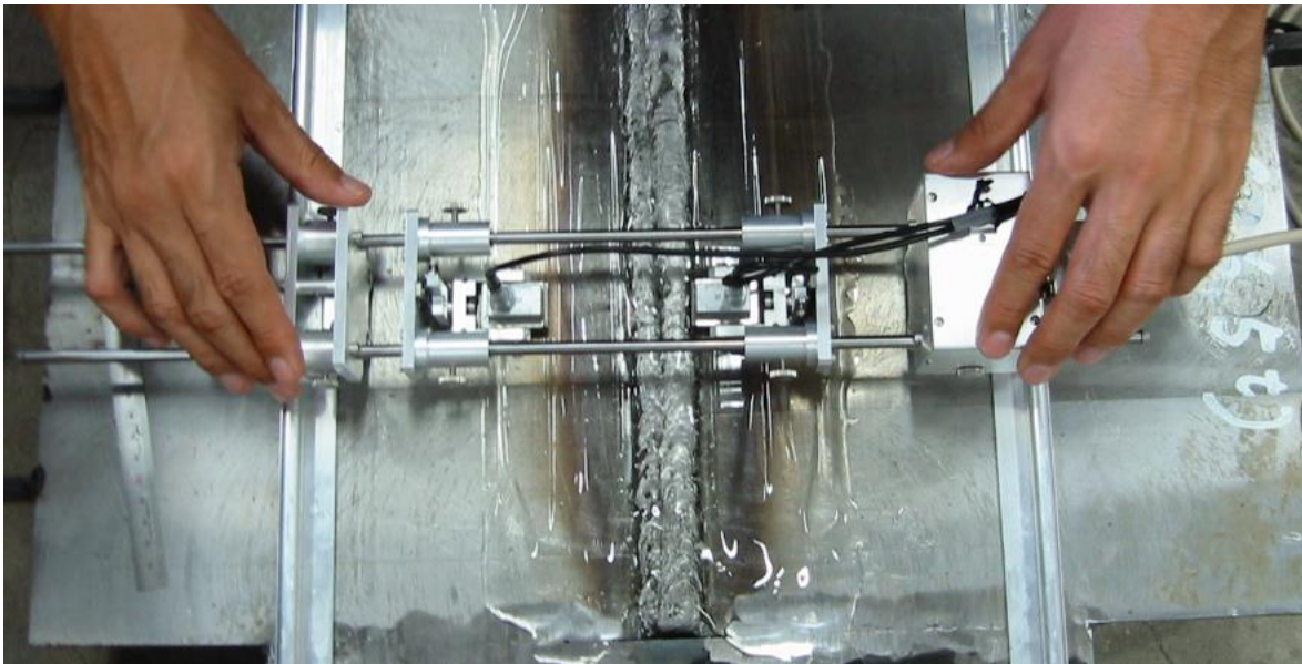
人工キズ付き試験体とTOFD用1軸スキャナ装置
